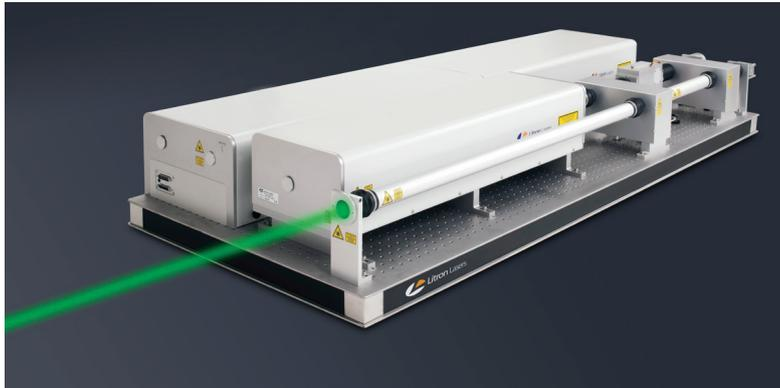
LPY 10 J 和 5 J 系统全部使用因瓦钢结构，有着优异的光学稳定性和机械稳定性。能量通过振荡器，和多级放大器组成。振荡器和放大器均采用谐振腔双棒上折射补偿技术搭建，有着最好的能量稳定性。光路之间内置集成隔离器，阻挡回光损坏光学元件。除了市场上常见的高斯非稳腔，我们同时提供望远镜稳腔系统。
